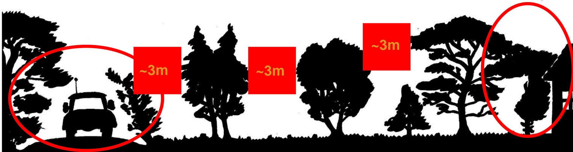
**4. Coupe et élimination des végétaux dans le périmètre des constructions (2m) et à l'aplomb des voies (gabarit 5\*5m)**
